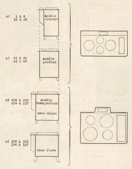
Tous ces fourneaux sont livrés avec bouillotte émaillée surélevée, seul dispositif permettant d'avoir de l'Eau très propre sans suie ni impuretés. Robinet à pression. grille à bois, grille à houille, et contrefeu raccourcissant le foyer dans les modèles profonds, avec tuyau tôle muni d'une clé, tisonnier, raclette, tampons à godet ou à trou. boutons, barre, robinet, bouillotte nickelés
